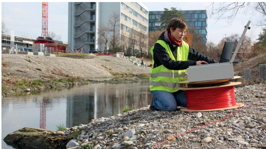
Bild 4. Die Forscherin Anne-Marie Kurth misst mit dem Glasfaserkabel feine Temperaturveränderungen im Flussbett. Daraus kann auf veränderte Wechselwirkungen zwischen Bach- und Grundwasser geschlossen werden. (© Andri Bryner, Eawag).
