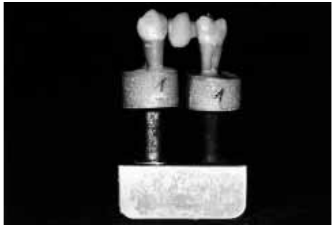
Abb. 7 Zur Belastung im Kausimulator bereite, auf dem Basissockel montierte, adhäsiv befestigte, modifizierte Seitenzahnbrücke.
