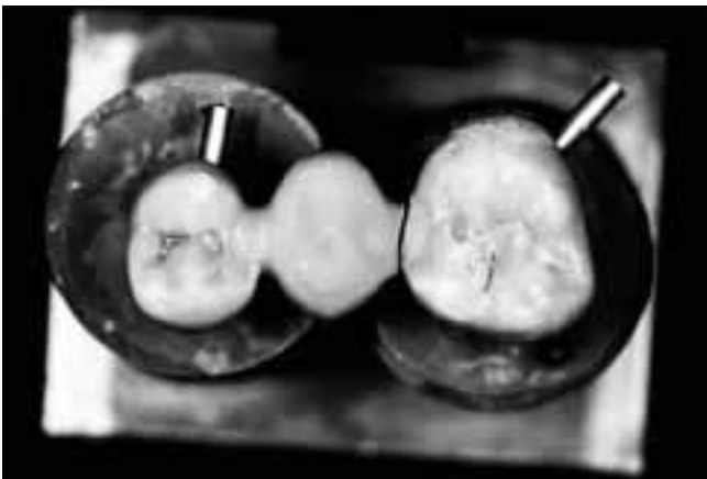
Abb. 11b Gebrochene Flügelbrücke von okklusal, es handelt sich um die Gruppe-3-Präparation ohne Rillen.
