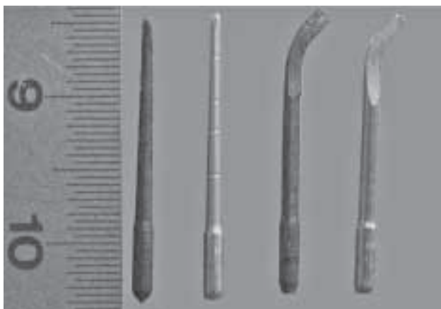
Abb. 1 Ansätze (von links nach rechts): gerade Karbonfaser-sonde, gerade Metallsonde, gebogene Karbonfaser-sonde, gebogene Metallsonde
