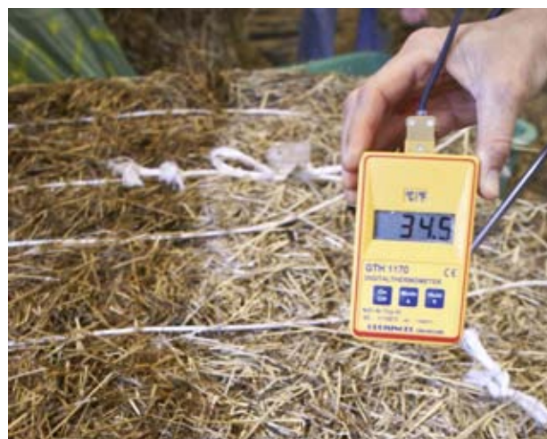
Abb. 3 | Die Temperaturmessungen sind ein guter und einfach zu bestimmender Indikator zur Bestimmung des Verderbs.
