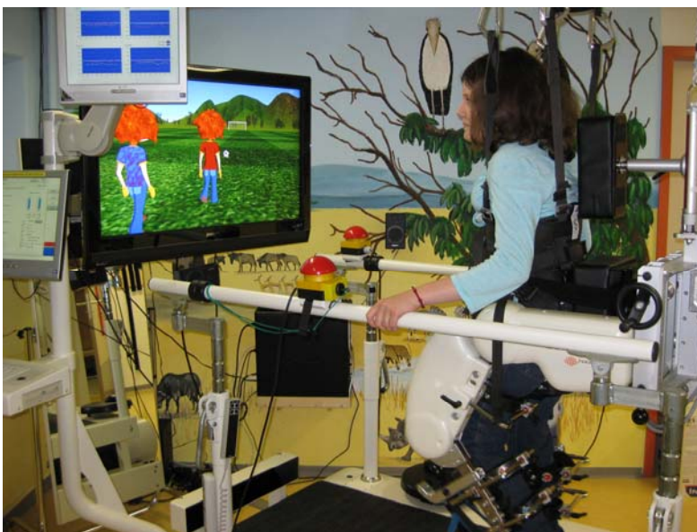
Abb. 2.: Kombination von RAGT mit VR-basiertem Feedbacksystem. Das multimodale Set-up umfasst das Laufband, den Lokomat®, ein 42 Zoll-Flachbildschirm mit Computer zum Abspielen der Spezialsoftware sowie ein 7.1 Dolby Surround Sound System.
