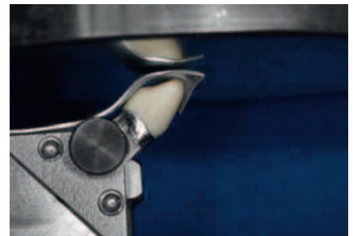
Abb. 14 Die Prüfanordnung nach Voss zur Bestimmung der Bruchlast.
