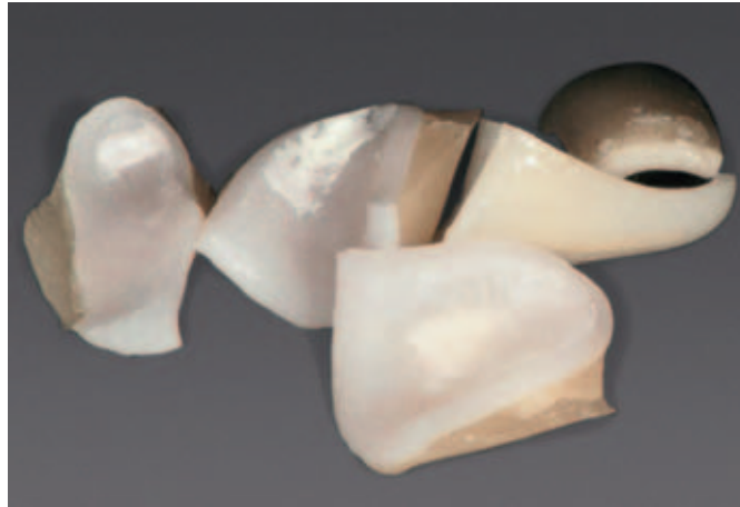
Abb. 17 Ein typisches Frakturmuster in der Verblendkeramik.
