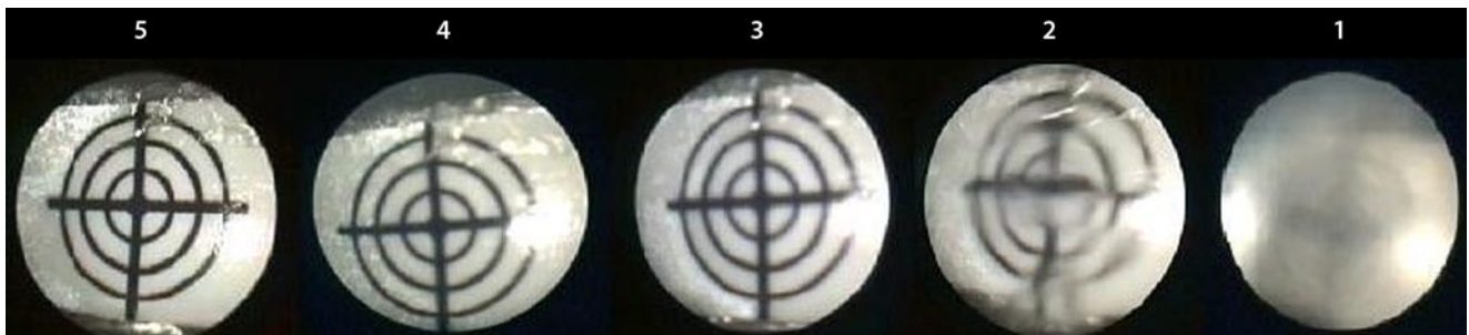
Abb. 4 ▲ Beispiel eines Testbilds je Gruppe nach Beurteilung der Aufnahmen durch die Fachärzte. 5 Testbild uneingeschränkt erkennbar, uneingeschränkte Intubationssicht; 4 Testbild gut erkennbar, gute Intubationssicht; 3 Testbild eingeschränkt erkennbar, eingeschränkte Intubationssicht; 2 Testbild kaum erkennbar, schlechte Intubationssicht; 1 Testbild nicht erkennbar, sehr schlechte Intubationssicht
