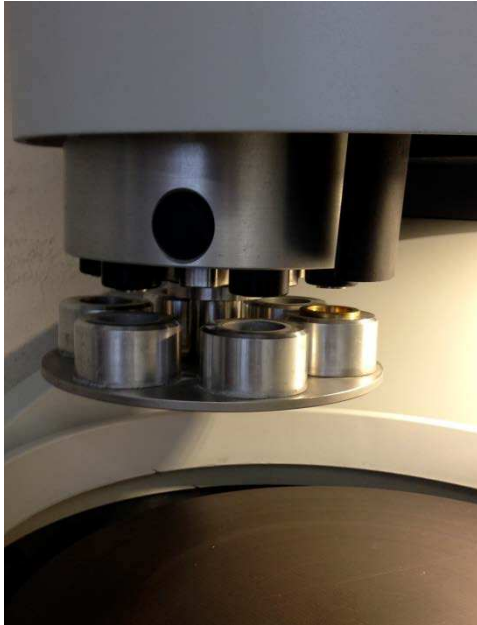
Abb. 5: Probenträger eingespannt in die Schleifmaschine
