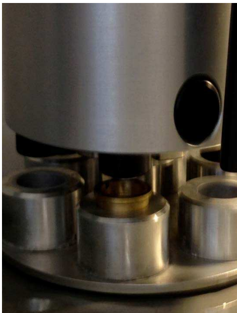
Abb. 6: Proben werden mit gleichem Druck planparallel geschliffen
